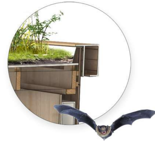
Holle dakrand zomerverblijven voor vleermuizen aan de westzijde
